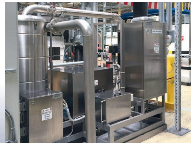
In unseren Sauganlagen werden mittels Unterdruck Abwasser und Partikel von den zu reinigenden Produkten entfernt, in Tanks gespeichert und diese dann später automatisch entleert.
